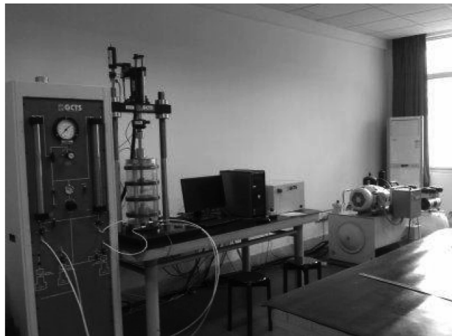
图1 美国进口 GCTS 动三轴试验系统仪
