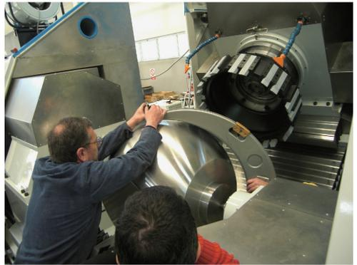
图 2 球面精度的人工在位检测
