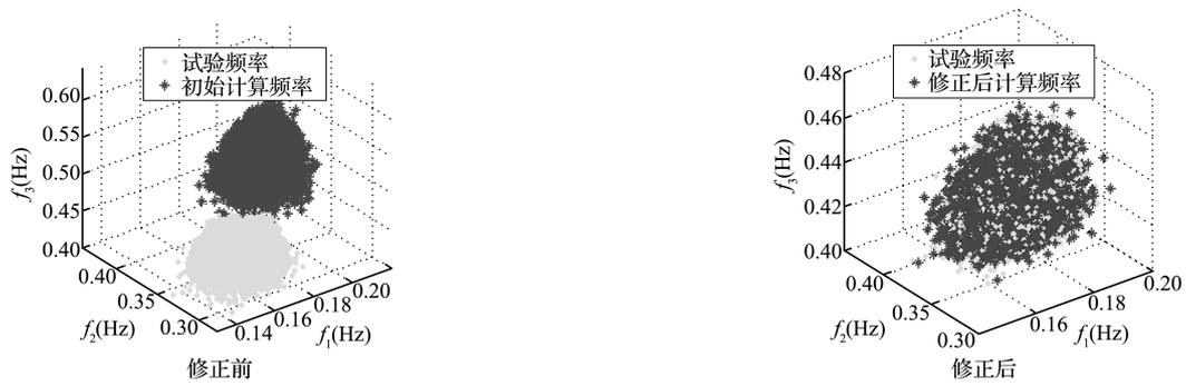
图6 试验样本数为10000时修正前后试验与计算频率散点图
