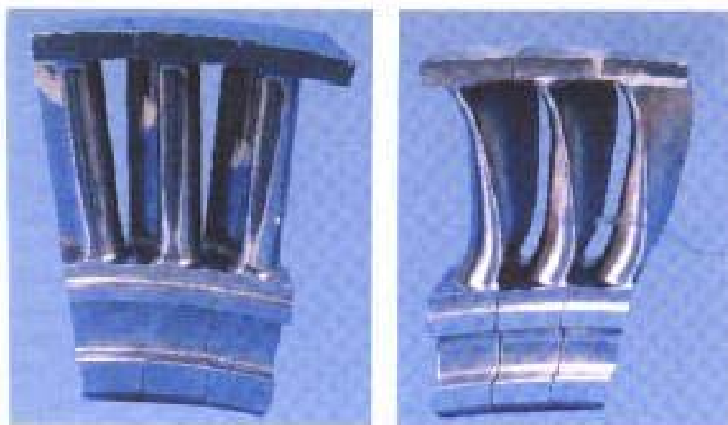
图7 带整体圆带的圆柱形叶片
