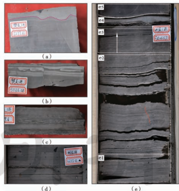
(a) 似槽模, 水流的涡流作用形成侵蚀凹坑; (b) 浊流粉砂; (c) 纹层间粉砂细层断续呈波状, 湖底短暂微弱缺氧, 微弱水动力; (d) 页理发育, 细层平直, 免受水动力扰动; (e) e1 水平层理段, 纹层较平直且连续; e2 波状层理段, 局部纹层出现揉皱甚至错断(红色线代表小断层); e3 水平层理段, 纹层平直连续, 自下至上纹层数量减少; e4 粉砂质透镜体被泥质沉积物包围; e5 块状层理, 几乎不见纹层。
