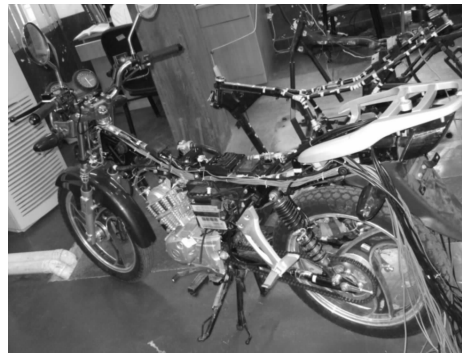
图 3 应变片和传感器布置实物图
