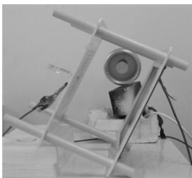
图 1 自制静电纺丝试验台
