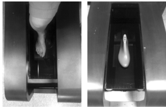
图1 足楦3D形貌自动测量平台
