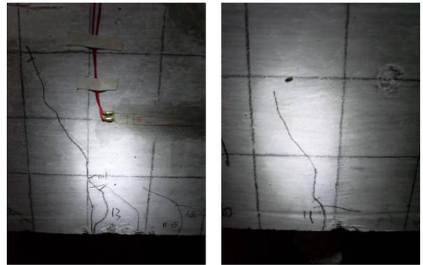
图7 再生混凝土主次裂缝中断、汇合
