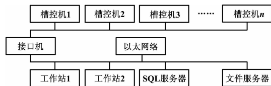
图 1 铝电解自动控制系统示意图
