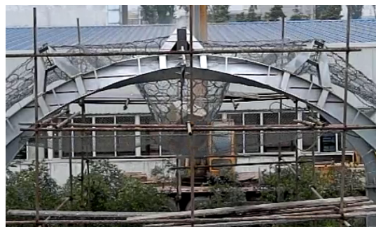
(b) 数值分析和试验得到的柔性棚洞在落石冲击到达最低点时的变形特征
