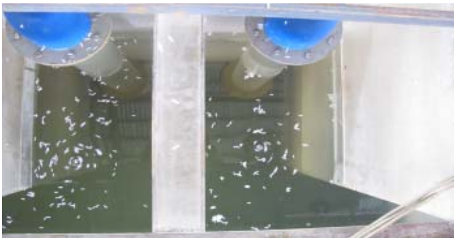
照片 1 设计方案泵前漩涡（组次 3）
