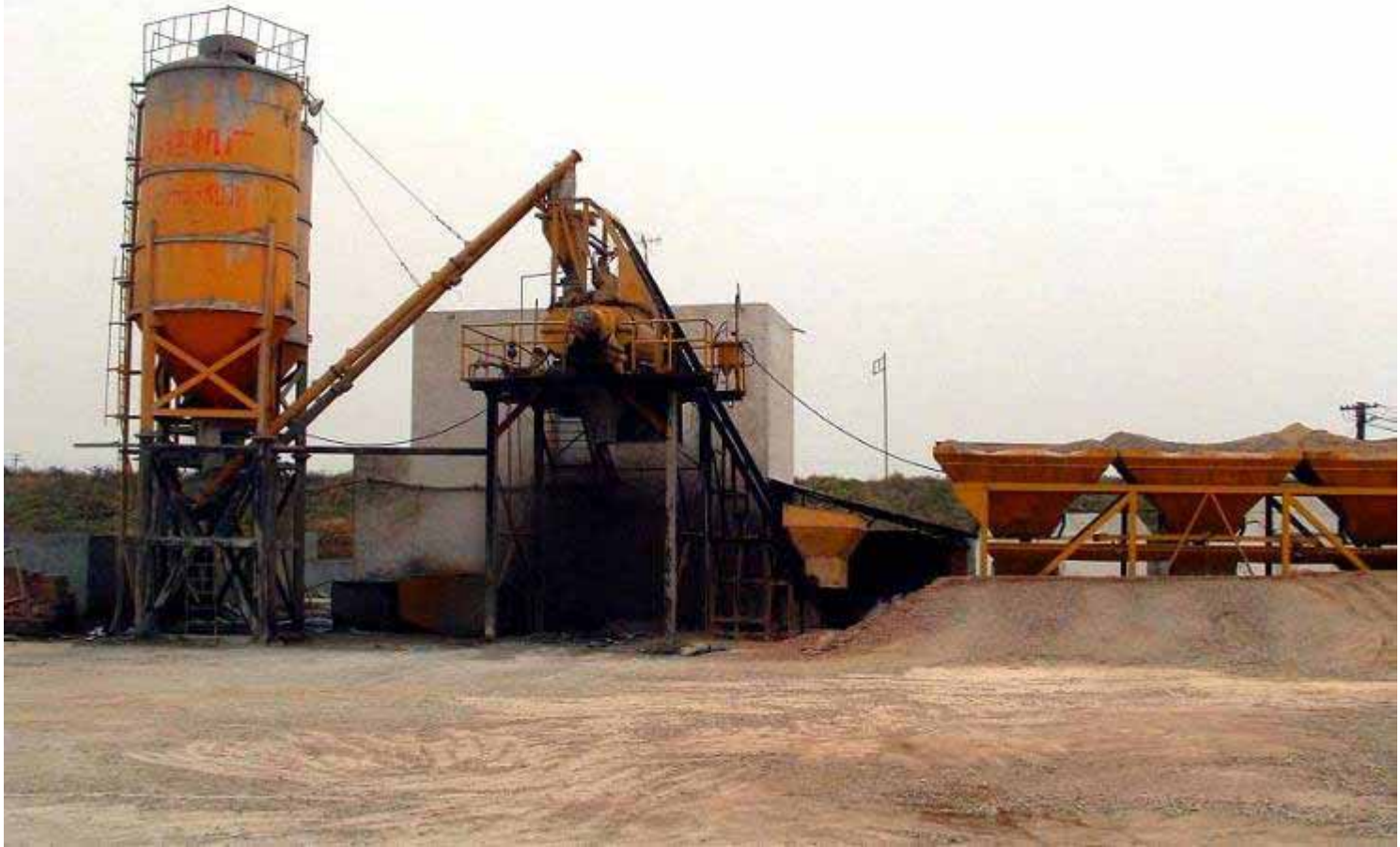
混凝土搅拌站
