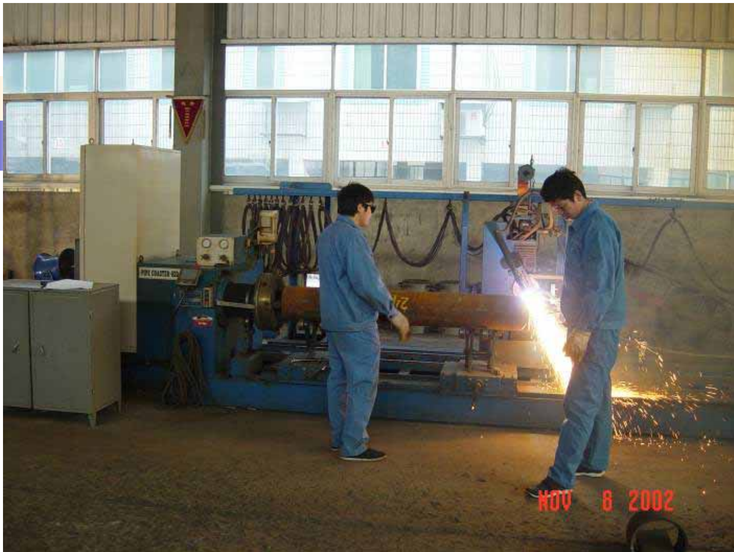
图为由计算机控制自动气割机进行相贯线切割。
