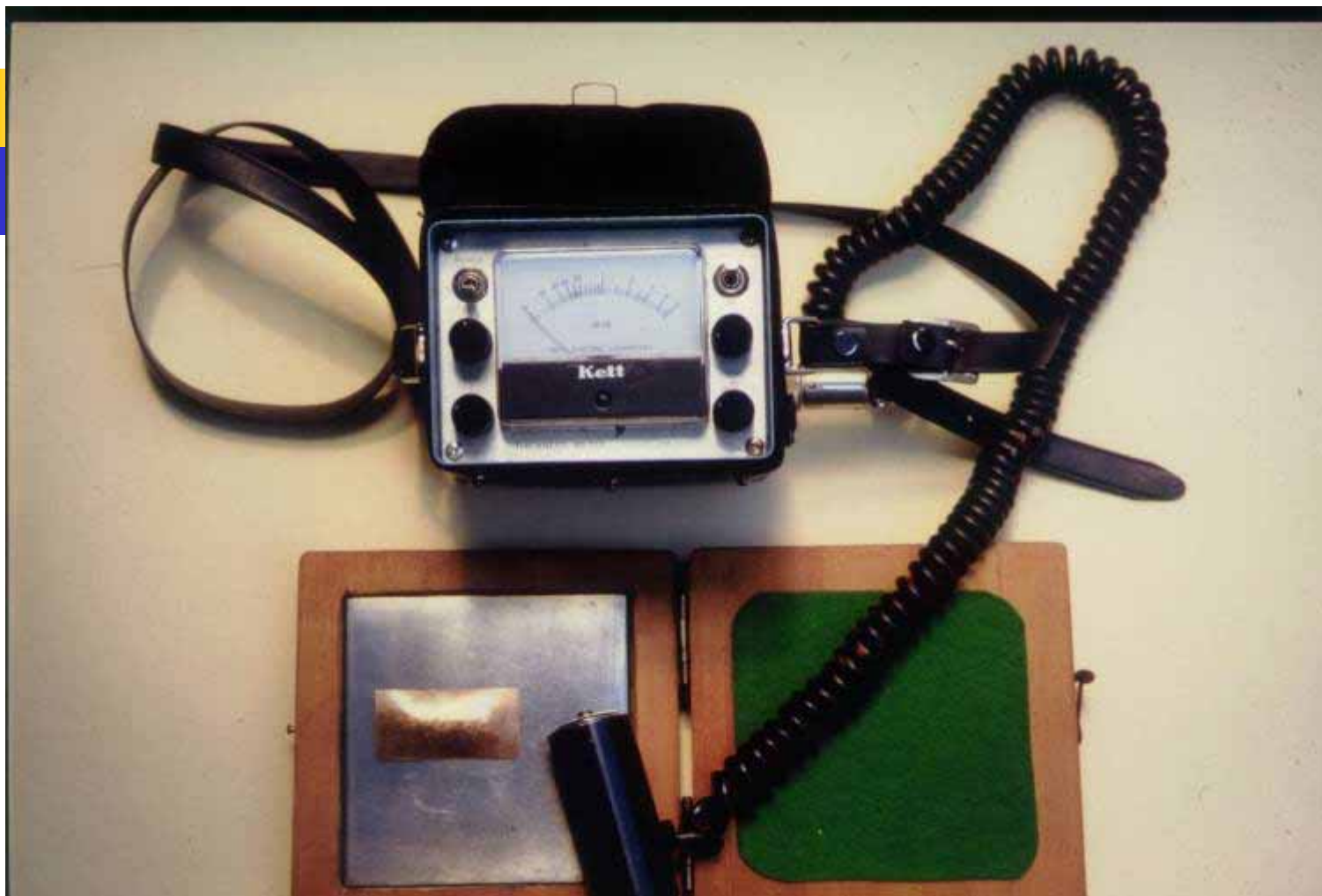
涂装漆膜测厚仪，其黄铜片为用于标定厚度的标准片。
