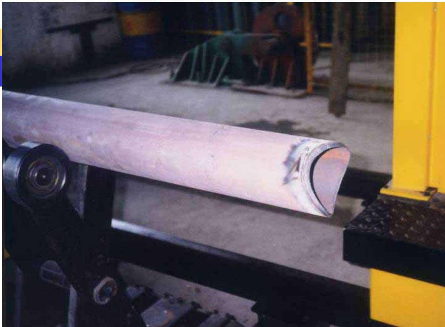
图为由计算机控制自动气割成型的相贯线切口。
