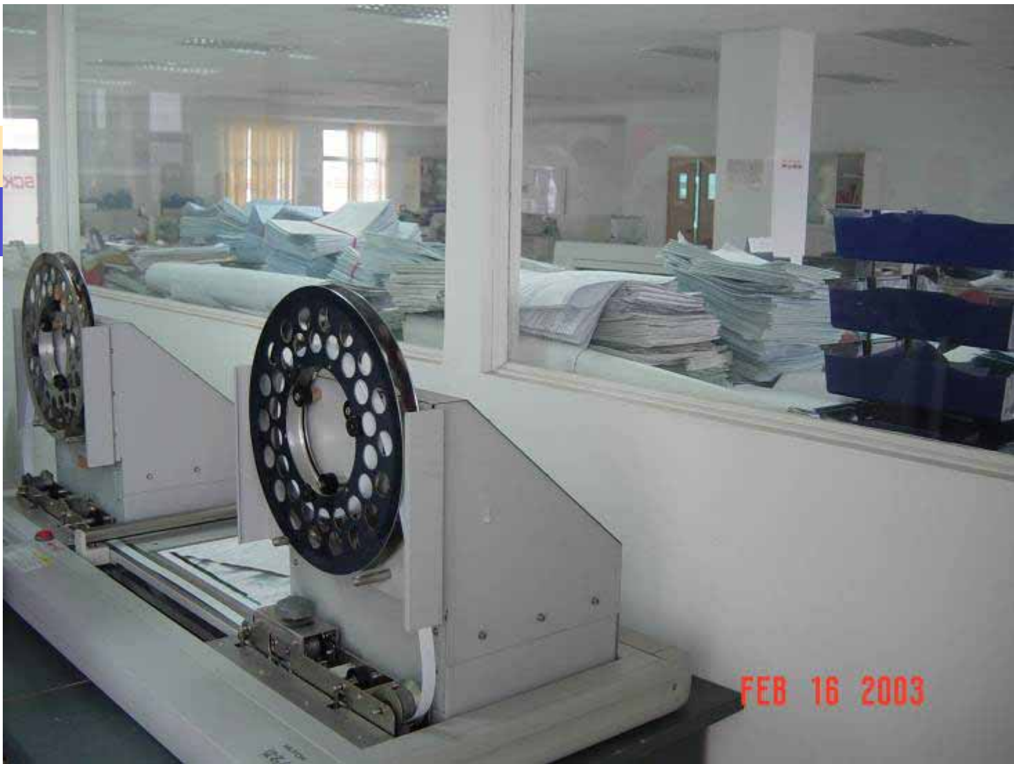
用计算机辅助放样后，打印样带
