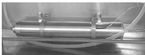
图 2 光谱吸收硫化氢气体浓度传感器气室
