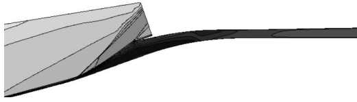
图 4 Ma=3.55, t=17\text{ms} 时不起动流场
