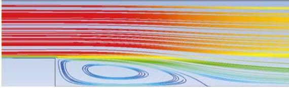
图7 使用标准  $k-\epsilon$  模型计算的平均流线图
