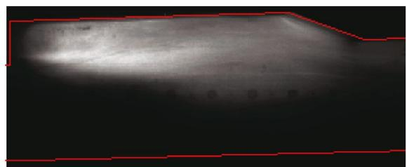
(c) 引导氢气关闭, 乙烯火焰稳定燃烧 ( $t=295.0\text{ ms}$ )
