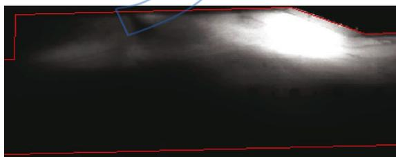
(c) 引导氢气关闭, 乙烯火焰稳定燃烧 ( $t=295.0$  ms)
