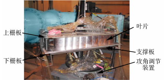
图 4 矩形涡轮叶栅实验台
