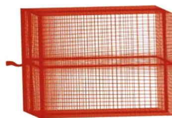
图 2 双 S 弯喷管计算网格 Fig. 2 Computational grid of double S-nozzle
