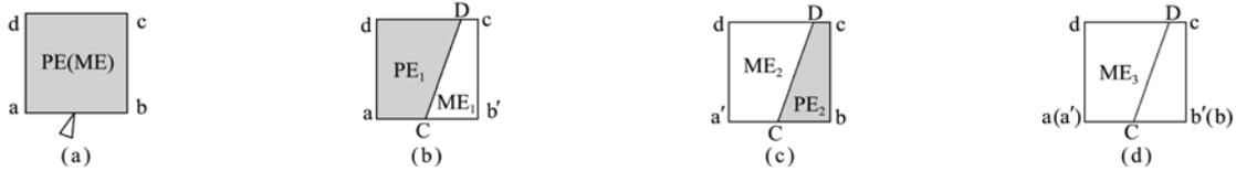
图4 非连续变形描述及粘聚裂纹单元
