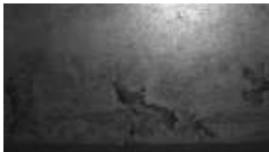
图4 Q690D钢板边部的星裂缺陷
