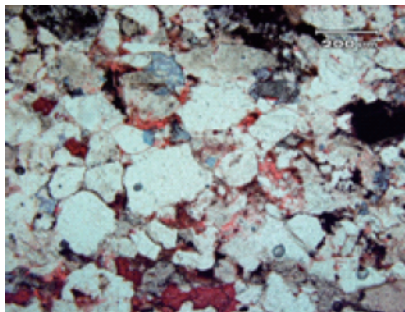
(d) 颗粒间线状紧密接触, 方解石、铁白云石充填孔隙 (d) Intergranular striation in close contact, ferroan calcite and ferroan dolomite fill pore
