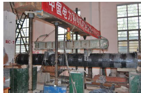
(c) 加载实物 (loading actual member)
