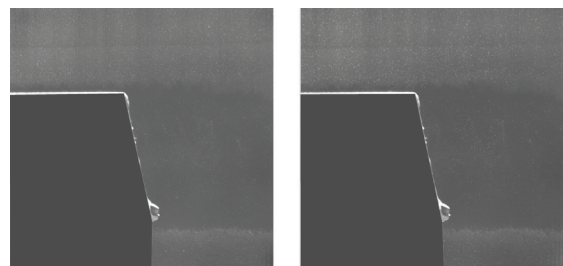
(a) 第一次激光脉冲示踪粒子图像 (the image of first pulse) (b) 第二次激光脉冲示踪粒子图像 (the image of second pulse)
