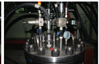
图 8 纳米示踪粒子发生器 Fig.8 Nano tracer particle generator
