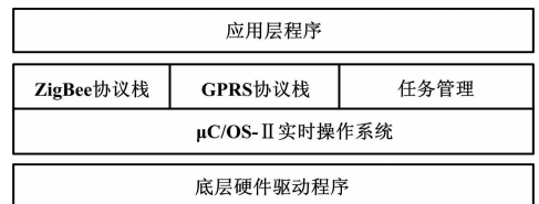
图 4 网关系统软件设计框图
