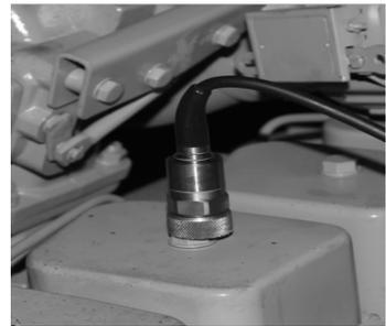
图 2 缸盖处的加速度传感器
