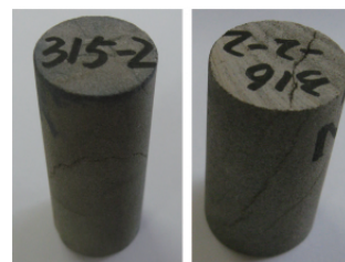
图 2 发育有微裂缝的样品
