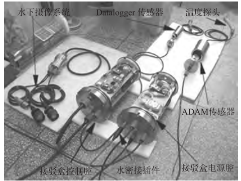
图 3 信息采集监测示范系统及接驳盒实物照片
