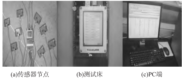
图 4 无线传感器网络的测试系统
