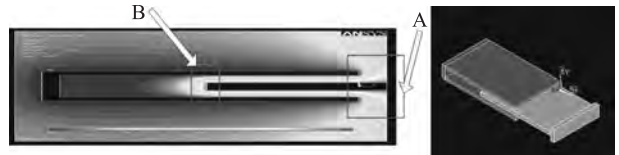
图3 微陀螺梳齿结构的电势分布和 Ansys 模型
