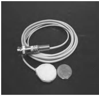
图 3 覆盖橡胶层的 PZT 压电陶瓷及金属背衬
