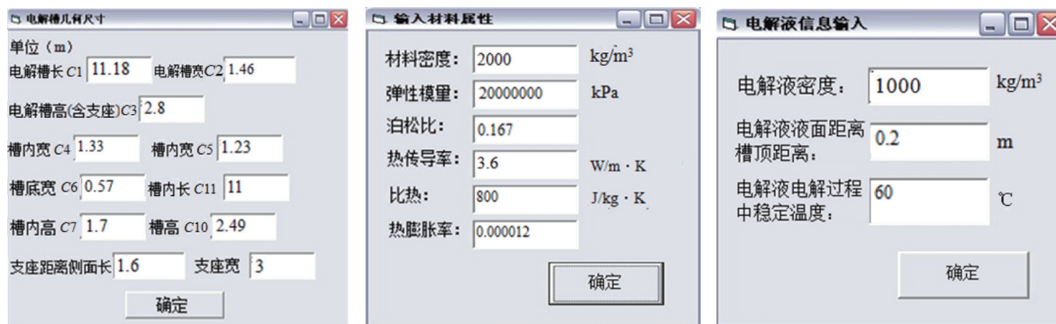
图 4 电解槽几何尺寸,材料属性及电解液信息
