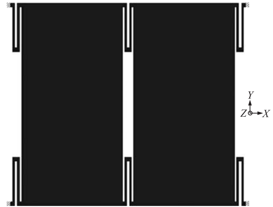
图 3 音叉式陀螺结构简化模型
