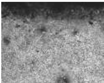
图2 剥落坑处的链状及棒状碳化物 200×
