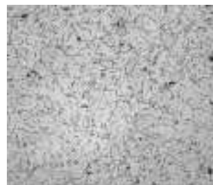
图7 筒体材料的金相组织 100×
