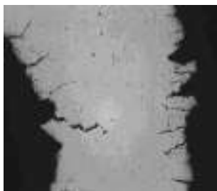
图5 皮下气孔间的沿晶裂纹形态 100×
