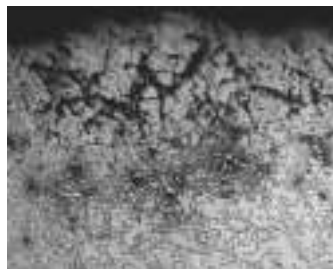
图3 剥落坑附近的晶间裂纹 200×
