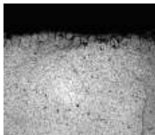
图4 皮下气孔附近的沿晶裂纹 100×
