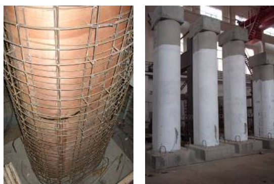
图 2 空心桥墩模型的制作流程
