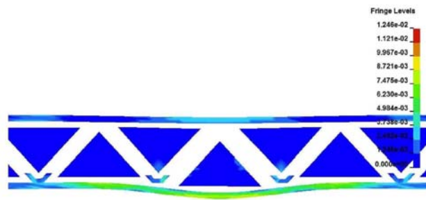
(b) 总结构在受侵彻 100 \mu\text{s} 时中心局部 von Mises 应力分布图 (焊点处剖面图)
