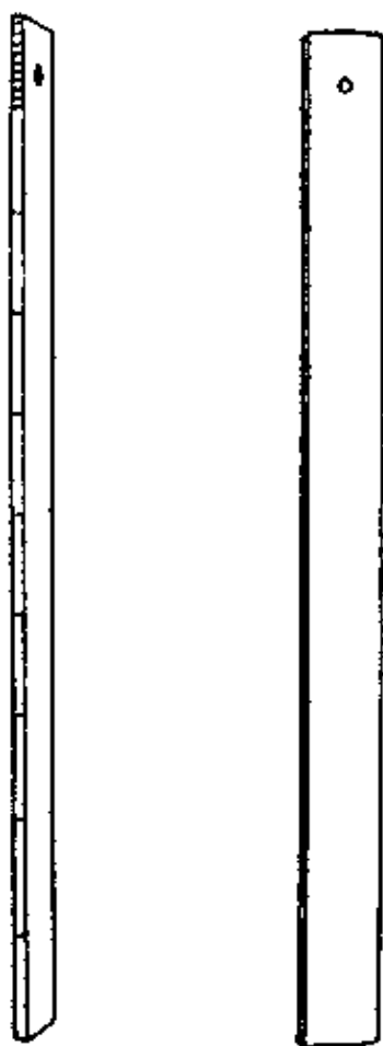
图 71 周代的十进度量衡制。公元前六世纪的青铜尺分成十寸,每寸又分成十分(根据福开森)
