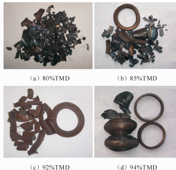
图 2 不同装药密度壳体的破片状态
