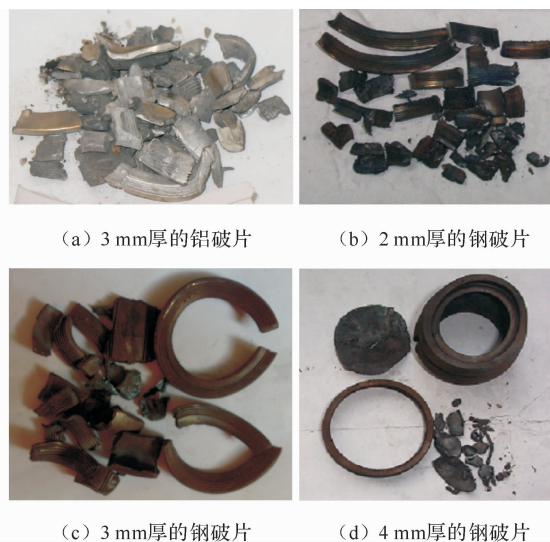
图 3 不同约束条件下壳体的破片状态
