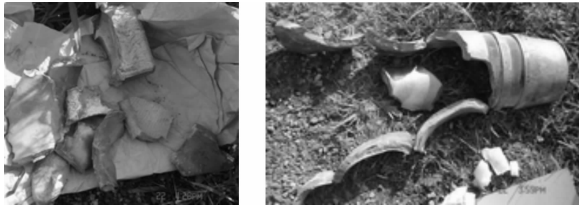
图 7 PELE 弹侵彻破坏钢筋混凝土后回收的部分碎片 Fig. 7 Recycle fragment of broken RC by PELE
