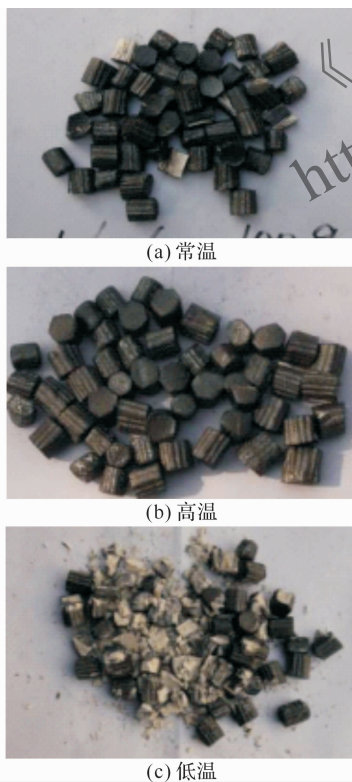
图 9 最大挤压应力相同、不同温度下发射药破碎情况
