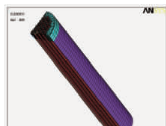
图 3 热交换器实体单元模型 Fig. 3 Solid element model of heat exchanger
