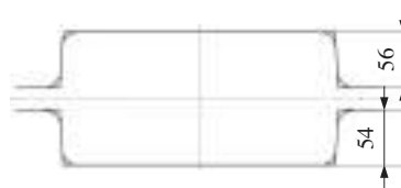
图4 配有2 mm下压力的成品孔
