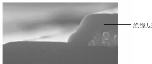
图 7 刻蚀时间为 2X 时,绝缘层的形貌图。
