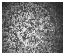
A 的扇形织构(降温至 34.9 \text{ }^\circ\text{C} )
