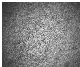
B 的指纹织构(升温至 84.4 \text{ }^\circ\text{C} )
