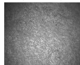
B 的指纹织构(升温至 84.4 \text{ }^\circ\text{C} )
