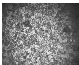
A 的菊花状螺旋织构 (降温至 60.0 \text{ }^\circ\text{C} )
