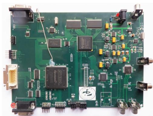
图 3 DSP 嵌入式系统电路板
