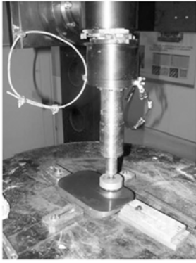
图 9 方形多丸片抛光盘加工碳化硅反射镜
