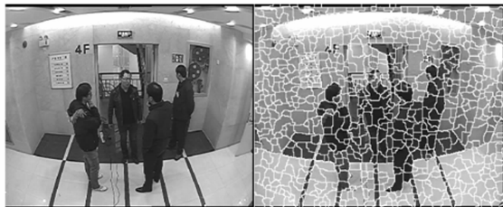
(a)原始图像 (b) Watershed 分割结果 (a)Original image (b) Result of Watershed
