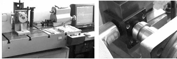
图 9 间隙测试实验 Fig.9 Backlash test
