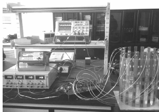
图 3 两相流 ERT 静态实验系统
